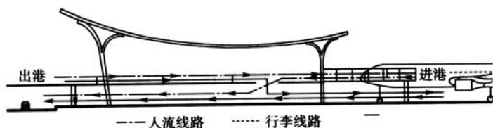
(a) 二层式剖面流程图
